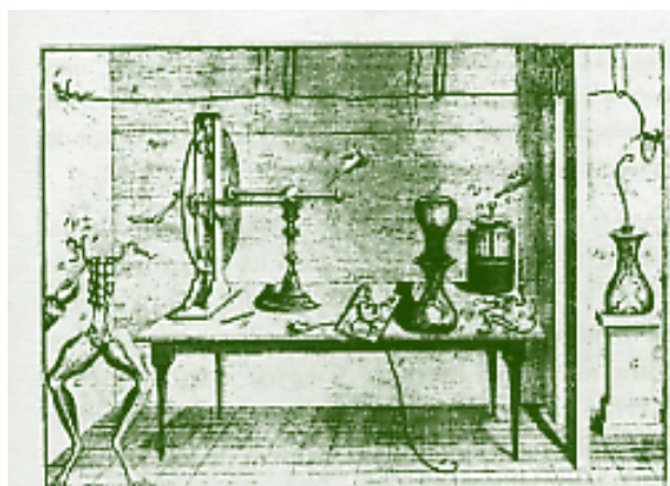
Fig. 1 La prima tavola del Commentario di Galvani Sulle Forze dell'elettricità nel moto muscolare . Si noti sulla sinistra la rana "preparata al modo di Galvani" e la macchina elettrica dalla quale viene estratta la scintilla.
